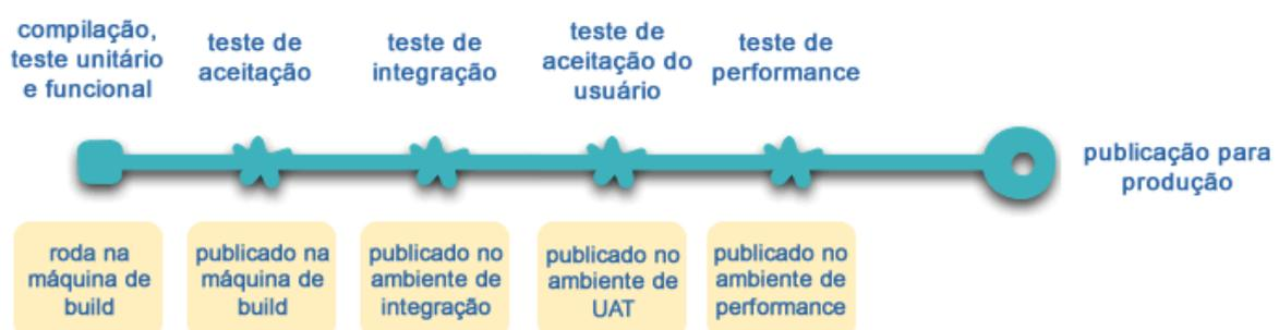
Figura 3: Pipeline básico de construção da aplicação.
