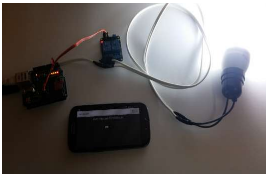
Figura 13. Protótipo da automação acionado por smartphone (Luz ligada)
