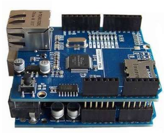
Figura 3. Arduino com Ethernet Shield acoplado
