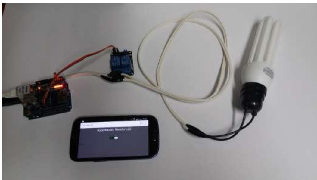
Figura 12. Protótipo da automação acionado por smartphone (Luz desligada)
