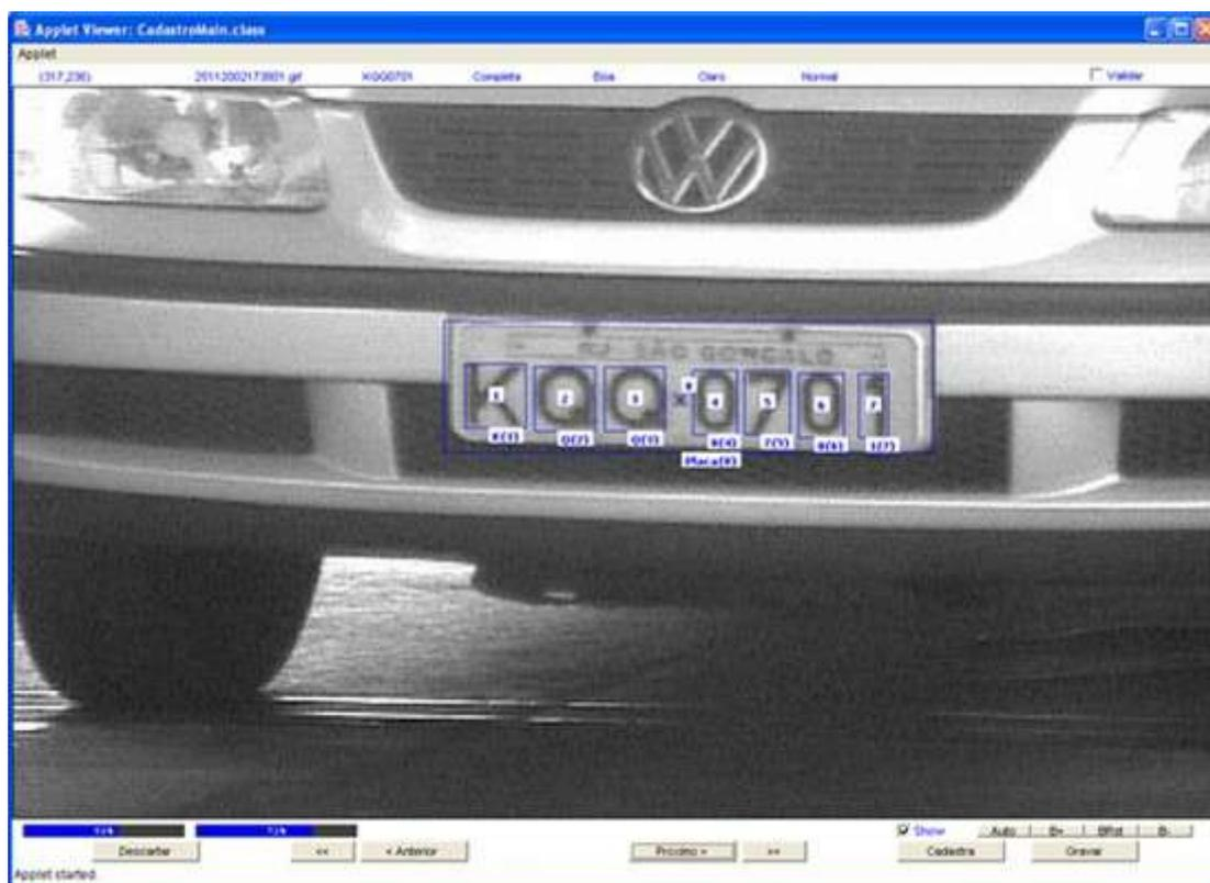
Figura 6. Exemplo de leitura de placa usando OPENCV
