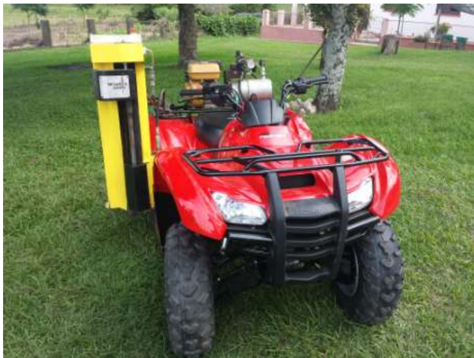
Figura 2: Quadrículo com equipamento que faz a coleta do solo
