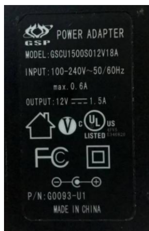
Figura 4. Especificações da fonte utilizada para alimentar o Arduino – Fonte: elaborado pelo autor.
